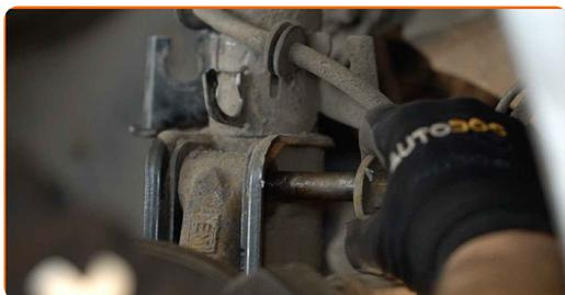
**14** Desconecte el muñón de dirección de la pata amortiguadora.
