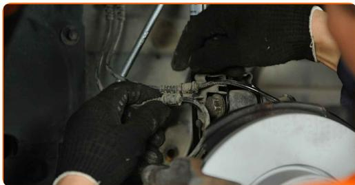
**57** Apriete la sujeción que conecta la bieleta a la barra estabilizadora. Usa una llave mixta del n.º 16. Use Vaso HEX No. H6. Utilice una llave dinamométrica. Apriételo a un par de 60 Nm.
