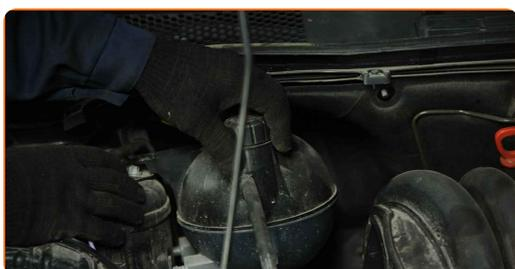
**19** Destornille la fijación superior de la cazoleta de la pata amortiguadora.
