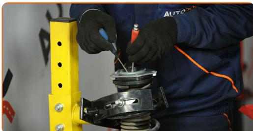
**26** Trate la varilla del amortiguador. Use un cepillo de alambre. Use el aerosol WD-40.
