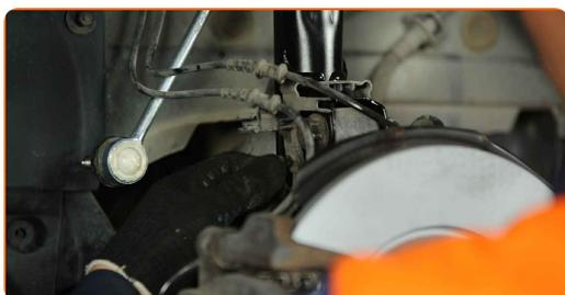
**55** Conecte la clavija del sensor de desgaste de las pastillas de freno.
