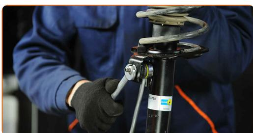
**44** Limpie los asientos de montaje del amortiguador. Use un cepillo de alambre. Use el aerosol WD-40.
