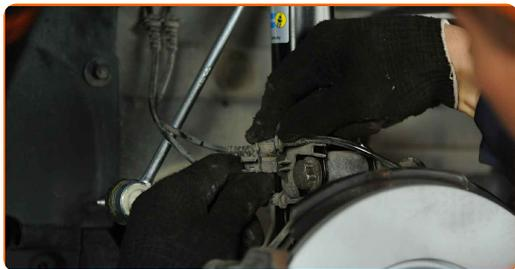
**56** Conecte los cables del captador ABS.
