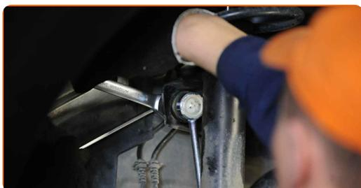
**13** Apriete la sujeción que conecta la bieleta a la barra estabilizadora. Usa una llave mixta del n.º 16. Utilice Torx T30. Utilice una llave dinamométrica. Apriételo a un par de 60 Nm.
