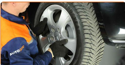
**Sustitución: copelas del amortiguador - Mercedes W169. Consejo de AUTODOC:**
