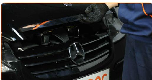
**16** Utilice un protector de aletas para evitar daños en la pintura y en las partes de plástico del automóvil.
