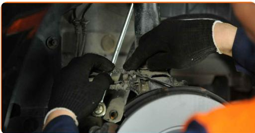
**9** Desconecte la fijación del cable del captador de desgaste de las pastillas de freno del strut. Use una palanca.
