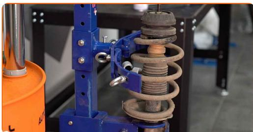
Sustitución: copelas del amortiguador - Mercedes W169. AUTODOC recomienda:
