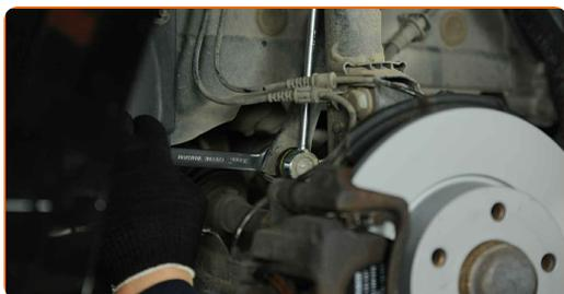
**8** Desconecte la fijación del cable del captador ABS. Use alicates de bomba de agua. Use una palanca.
