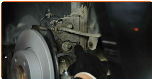
**40** Conecte la clavija del sensor de desgaste de las pastillas de freno.
