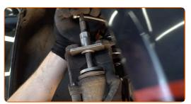
Establezcan el soporte de freno y lo fijen. Usa una llave mixta del n.º 13. Usa una llave mixta del n.º 15. Utilice una llave dinamométrica. Apriételo a un par de 35 Nm.
