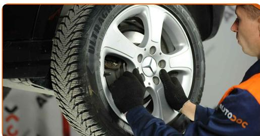
**7** Limpie las sujeciones de la pinza del freno. Use un cepillo de alambre. Use el aerosol WD-40.
