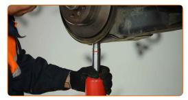
Limpie las sujeciones del amortiguador. Use un cepillo de alambre. Use el aerosol WD-40.
