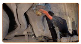
Instale el resorte helicoidal junto con los soportes de montaje de goma en los asientos de montaje. Use una palanca.
