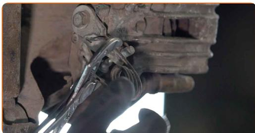
**15** Retire el clip de sujeción del cable del freno de estacionamiento. Use una palanca.
