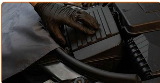
**11** Atornille los tornillos de sujeción de la cubierta del filtro de aire. Utilice un destornillador Phillips.
