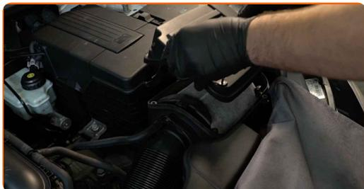
**5** Desenrosque el soporte de la carcasa del filtro de aire. Utilice un destornillador Phillips.
