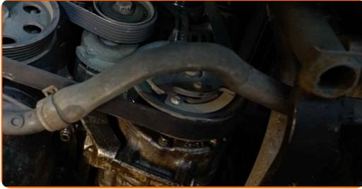
8 Vuelva a colocar la polea tensora en su posición inicial. Usa una llave mixta del n.º 16.
