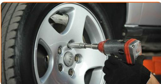
**24** Baje el automóvil y, manteniendo el orden cruzado, apriete los pernos de fijación de las ruedas. Utilice una llave de impacto para llanta # 17. Utilice una llave dinamométrica. Apriételo a un par de 120 Nm.
