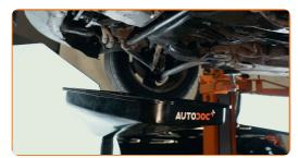
Limpie el área del orificio de drenaje de la bandeja de aceite. Limpie el filtro de aceite. Use un cepillo de alambre. Utilice un spray de limpieza multiuso.
