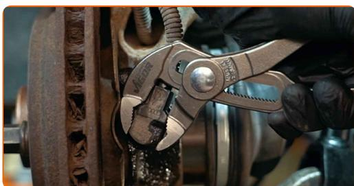
**11** Limpie el asiento de montaje del sensor ABS. Use un cepillo de alambre. Use el aerosol WD-40. Use un limpiador de frenos.
