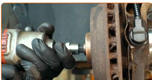
**16** Retire el perno de sujeción.
