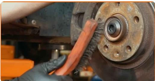
**22** Trate la superficie donde el disco del freno entra en contacto con la llanta de la rueda. Use grasa de cobre.
