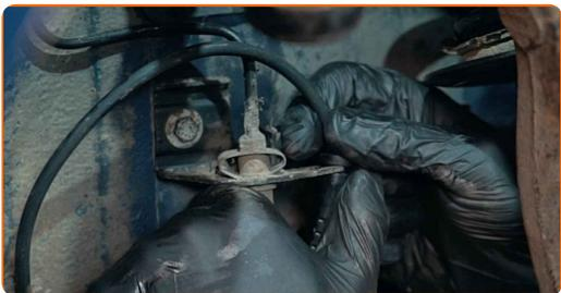
**19** Trate el conector del sensor ABS. Utilice grasa dieléctrica.
