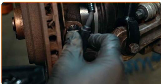
**14** Conecte los cables del captador ABS.
