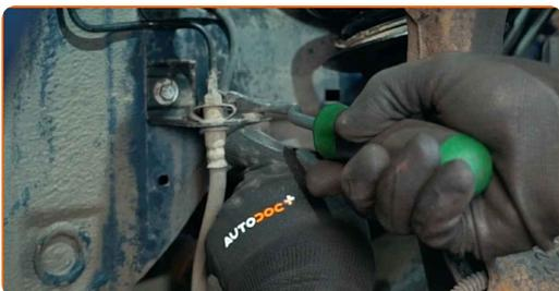
**8** Suelte el conector del sensor ABS.
