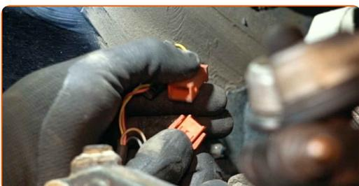
**9** Limpie la sujeción del sensor del ABS. Use el aerosol WD-40.
