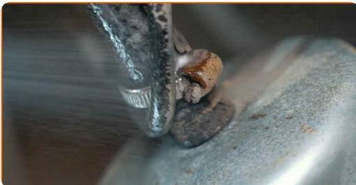
9 Afloje las abrazaderas de sujeción de los tubos del filtro de combustible. Utilice un destornillador plano.
