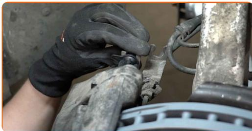
**24** Conecte la clavija del sensor de desgaste de las pastillas de freno.
