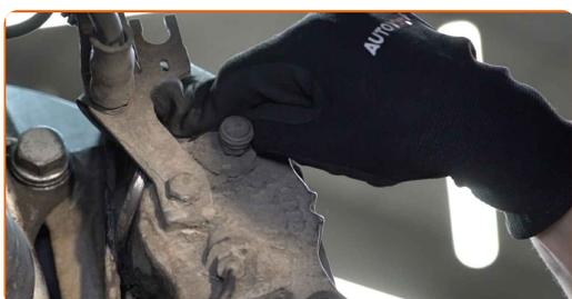
**22** Instale el resorte de fijación del cáliper de freno. Use una palanca.
