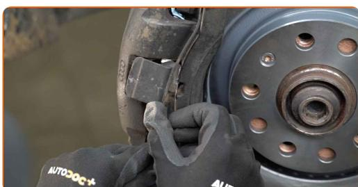
**23** Conecte el captador de desgaste de las pastillas de freno.
