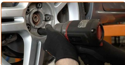
**31** Baje el automóvil y, manteniendo el orden cruzado, apriete los pernos de fijación de las ruedas. Utilice una llave de impacto para llanta # 17. Utilice una llave dinamométrica. Apriételo a un par de 120 Nm.
