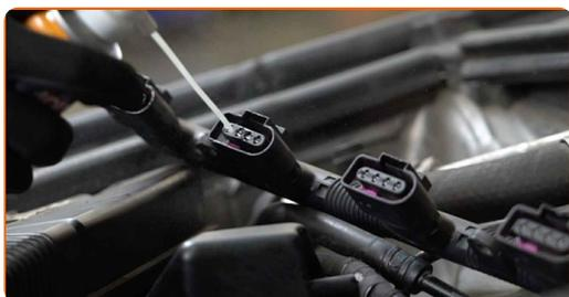
**14** Conecte los conectores de las bobinas del encendido.
