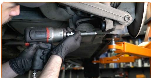
**12** Destornille la fijación superior del amortiguador. Use un vaso de impacto del n.º 16. Utilice una llave de trinquete.
