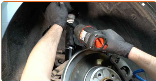
**28** Instale el perno de sujeción.
