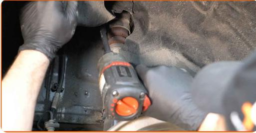
**13** Retire el perno de sujeción.
