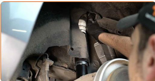
**27** Atornille la sujeción superior del amortiguador. Use un vaso de impacto del n.º 16. Utilice una llave de trinquete.
