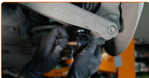
**29** Atornille la sujeción inferior del amortiguador. Use un vaso de impacto del n.º 21. Utilice una llave de trinquete.
