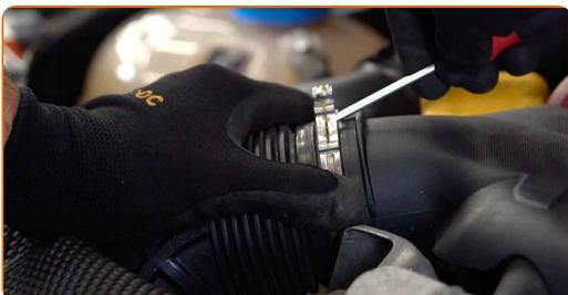
**4** Suelte la abrazadera del manguito de ventilación del cárter. Utilice un destornillador plano.
