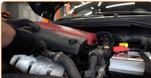
**8** Desconecte la manguera de ventilación del cárter del conducto de aire.
