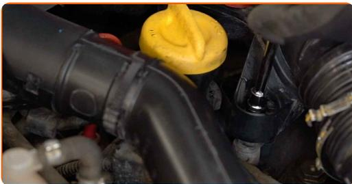
**37** Conecte el tubo de entrada de aire a la carcasa del filtro de aire.
