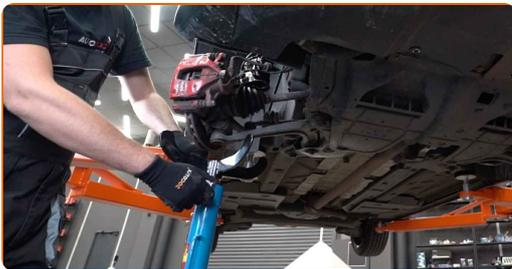
**35** Conecte la fijación del cable del sensor ABS a la pata amortiguadora. En la pata fije el latiguillo del sistema de freno.
