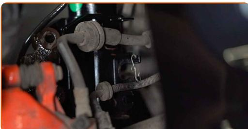
**32** Fije la pata amortiguadora en el muñón de dirección. Instale los nuevos pernos de la mangueta de dirección.
