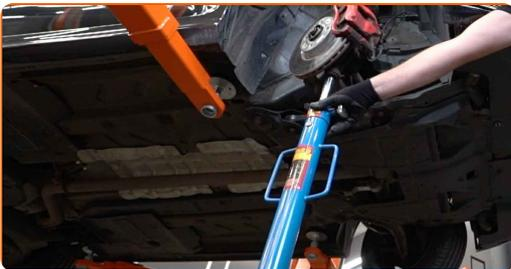
16 Desatornille la sujeción inferior que conecta el puntal amortiguador a la mangueta de dirección. Utilice la llave de estrella acodada #17. Use un vaso de impacto del n.º 15. Utilice una llave de trinquete.
