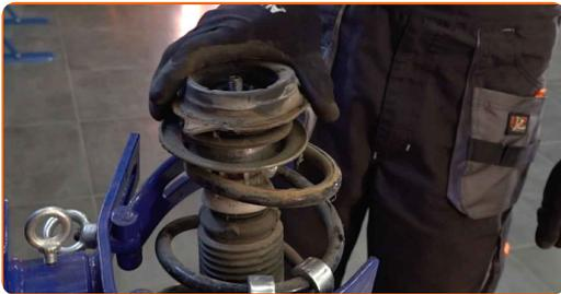
**26** Instale el soporte superior, el cojinete de apoyo y el platillo superior del resorte. Use una palanca.
