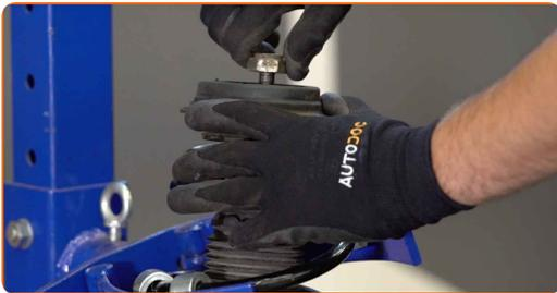
**27** Apriete la tuerca de la varilla de la pata amortiguadora. Utilice la llave de estrella acodada #27. Use Vaso HEX No. H7. Utilice una llave dinamométrica. Apriételo a un par de 60 Nm.
