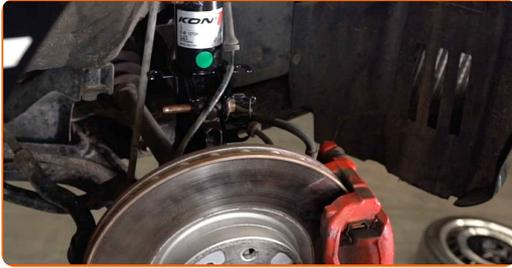
**33** Apriete las sujeciones inferiores que conectan el amortiguador con la mangueta de dirección. Use un vaso de impacto del n.º 15. Utilice la llave de estrella acodada #17. Utilice una llave dinamométrica. Apriételo a un par de 85 Nm.
