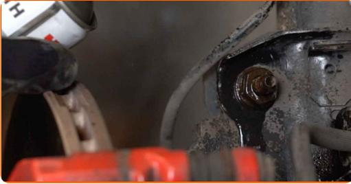
14 Destornille la tuerca y quite la barra del estabilizador desde la pata amortiguadora. Utilice la llave de estrella acodada #18. Use un vaso de impacto del n.º 18. Use Vaso HEX No. H5.
