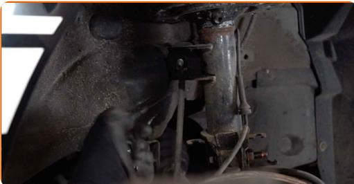
15 Sostenga el muñón de dirección. Utilice un gato de transmisión hidráulica.
