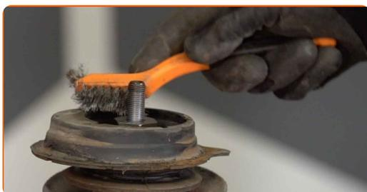
**24** Destornille la tuerca de la varilla de la pata amortiguadora. Usa una llave mixta del n.º 27. Use Vaso HEX No. H7.
