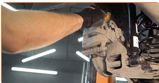
**7** Destornille la fijación del cáliper de freno. Use un vaso de impacto del n.º 13. Utilice una llave de trinquete.
