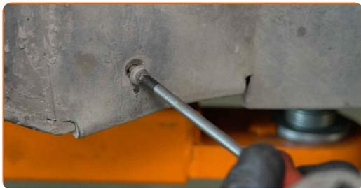
**24** Retire la cubierta del paso de rueda.
