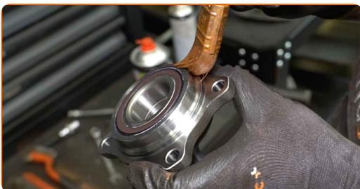
**56** Inserte presionando el rodamiento nuevo en el muñón de dirección. Utilice un juego de cubos y rodamientos.
