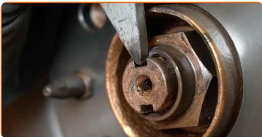
**100** Trate todas las articulaciones del brazo. Trate las sujeciones de la mangueta de dirección. Use grasa de cobre.
