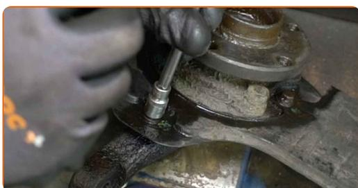
**44** Retire la cubierta del disco de freno.
