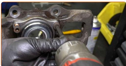
**58** Apriete la sujeción del rodamiento de cubo de rueda. Use Vaso HEX No. H8. Utilice una llave dinamométrica. Apriételo a un par de 76 Nm.
