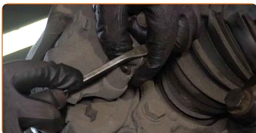
**12** Destornille la fijación del cáliper de freno. Use Vaso HEX No. H7. Utilice una llave de trinquete.
