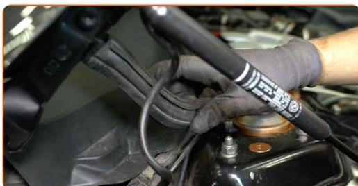
**27** Desconecte el cableado del captador ABS. Utilice un destornillador plano.
