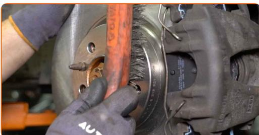
**102** Trate la superficie donde el disco del freno entra en contacto con la llanta de la rueda. Use grasa de cobre.
