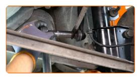
Trate todas las juntas de la bieleta o enlace estabilizador. Use grasa de cobre.
