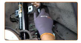
Apriete las fijaciones de la bieleta de la barra estabilizadora. Usa una llave mixta del n.º 17. Use Vaso HEX No. H5. Utilice una llave de trinquete.
