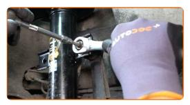
Desatornille la sujeción que conecta la bieleta a la barra estabilizadora. Usa una llave mixta del n.º 17. Use Vaso HEX No. H5. Utilice una llave de trinquete.
