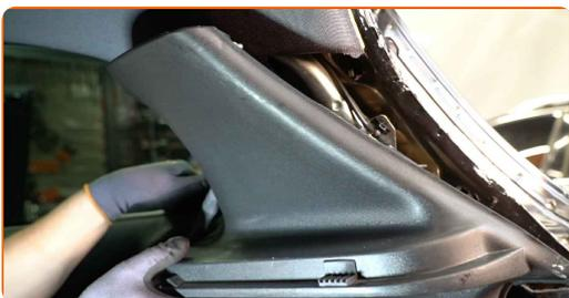
**16** Limpie la sujeción superior del soporte del puntal de suspensión. Use el aerosol WD-40.
