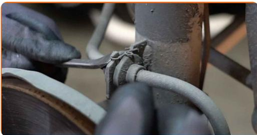
**23** Separe el latiguillo de freno del puntal amortiguador.
