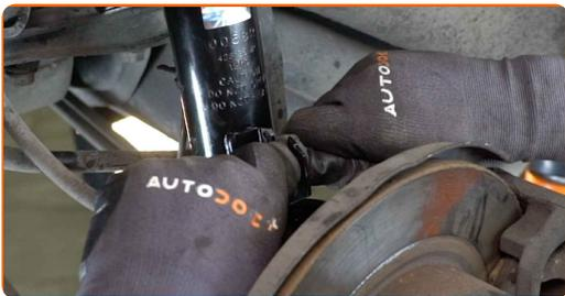
**68** Instale la abrazadera de retención del latiguillo de freno. Use una palanca.
