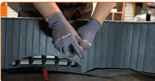
**6** Afloje los ganchos que fijan el revestimiento del maletero. Use Vaso HEX No. H5. Utilice una llave de trinquete.
