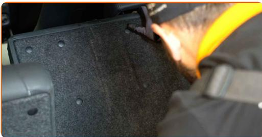
**5** Desenrosque la sujeción del panel de plástico protector central. Utilice un destornillador Phillips.
