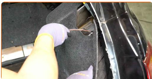
**81** Atornille las sujeciones del revestimiento de la parte lateral del maletero. Utilice un destornillador Phillips.
