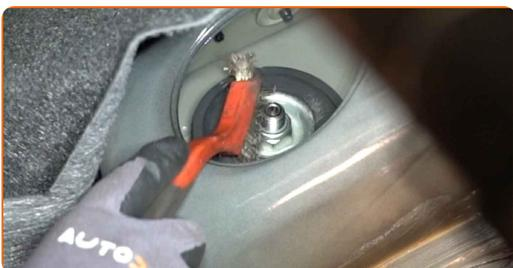
**17** Afloje la sujeción superior del soporte del amortiguador. Use Vaso HEX No. H6. Use un vaso de impacto del n.º 22. Utilice una llave de trinquete.
