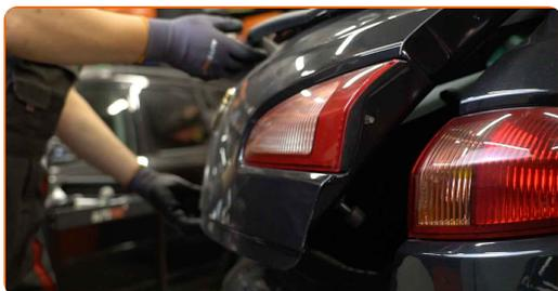
**3** Mueva el estante plegable y libérela de las sujeciones. Al efectuar esto, obtendrá acceso a los paneles de plástico del revestimiento lateral.
