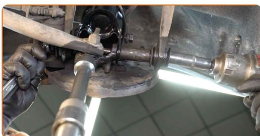
**59** Atornille la sujeción que conecta el amortiguador con la mangueta trasera. Usa una llave mixta del n.º 19. Use un vaso de impacto del n.º 19. Utilice una llave de trinquete.
