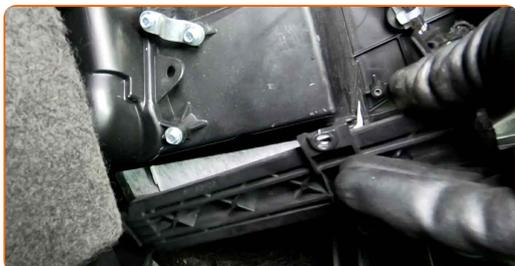
**10** Atornille las sujeciones de la cubierta de la carcasa del filtro de habitáculo. Use un vaso de impacto del n.º 5.5. Utilice una llave de trinquete.
