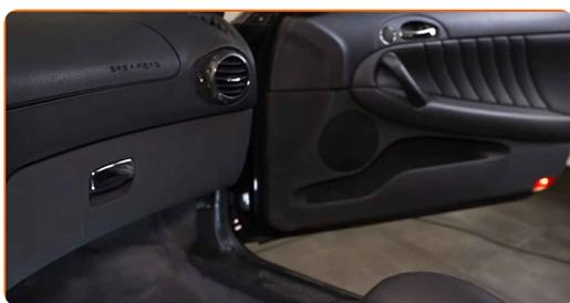
**2** Extienda un trapo debajo de la cubierta del filtro de la cabina para proteger la tapicería interior de la suciedad.
