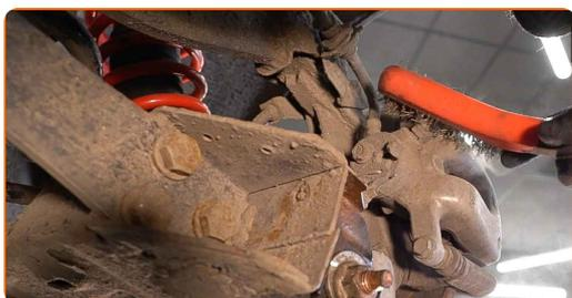
**8** Destornille la fijación del cáliper de freno. Usa una llave mixta del n.º 13. Usa una llave mixta del n.º 15.
