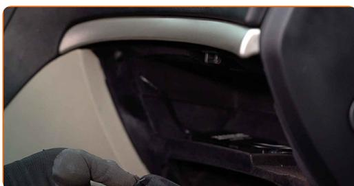
**3** Deshaga el tornillo del revestimiento de la guantera y extraiga dicho revestimiento. Utilice un destornillador plano. Utilice un destornillador Phillips.
