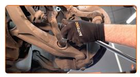
Retire el perno de sujeción.
