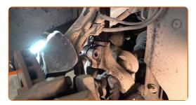
Instale el perno de sujeción.
