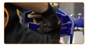
Limpie la barra del amortiguador. Use un cepillo de alambre. Use el aerosol WD-40.
