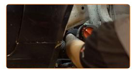
Retire el enlace estabilizador de estabilidad transversal.
