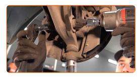
Apriete el perno de sujeción que conecta el puntal de suspensión con la horquilla del amortiguador. Use un vaso de impacto del n.º 18. Utilice una llave dinamométrica. Apriételo a un par de 77 Nm.
