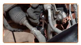
Apriete la sujeción que conecta la bieleta de barra estabilizadora con la horquilla del amortiguador. Usa una llave mixta del n.º 18. Use Vaso HEX No. H6. Utilice una llave dinamométrica. Apriételo a un par de 60 Nm.
