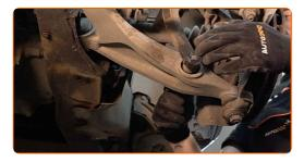
Limpie la sujeción que conecta la horquilla del amortiguador al puntal de suspensión. Use un cepillo de alambre. Use el aerosol WD-40.
