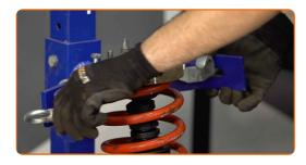
Retire el puntal amortiguador que está montado.
