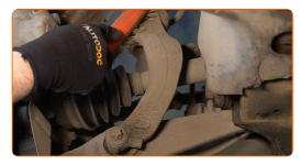
Deshaga la tuerca de sujeción que conecta la bieleta de barra estabilizadora con la horquilla del amortiguador. Use un vaso de impacto del n.º 18.
