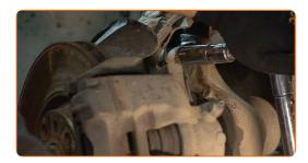
Apriete el perno de sujeción que conecta la horquilla del amortiguador con el brazo de control inferior. Use un vaso de impacto del n.º 21. Utilice una llave dinamométrica. Apriételo a un par de 55 Nm.+45°
