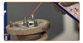
Destornille la tuerca de la varilla de la pata amortiguadora. Usa una llave mixta del n.º 18. Use un vaso de impacto del n.º 6. Utilice una llave de trinquete.
