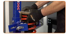
Apriete la tuerca de la varilla de la pata amortiguadora. Usa una llave mixta del n.º 6. Usa una llave mixta del n.º 18. Use un vaso de impacto del n.º 18. Utilice una llave dinamométrica. Apriételo a un par de 33 Nm.
