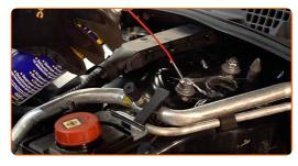
Afloje la sujeción superior del soporte del amortiguador. Use un vaso de impacto del n.º 16. Utilice una llave de trinquete.
