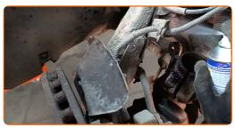
Fije la horquilla del amortiguador al puntal de suspensión. Utilice un mazo de goma.
