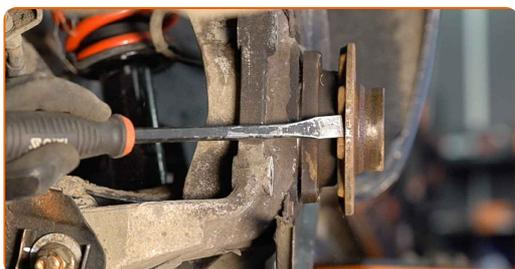
**21** Limpie el asiento de montaje del cojinete del cubo (buje). Use un cepillo de alambre. Utilice un spray de limpieza multiuso.
