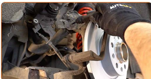
**30** Apriete la fijación de la pinza del cáliper de freno. Use un vaso de impacto del n.º E12. Utilice una llave dinamométrica. Apriételo a un par de 60 Nm.
