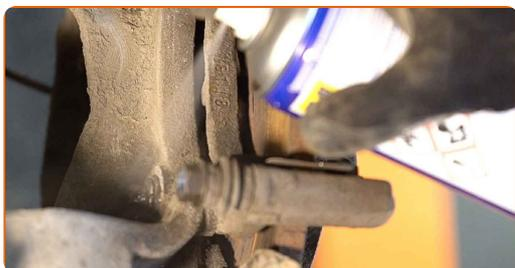
**12** Destornille la fijación de la pinza del cáliper de freno. Use un vaso de impacto del n.º E12. Utilice una llave de trinquete.
