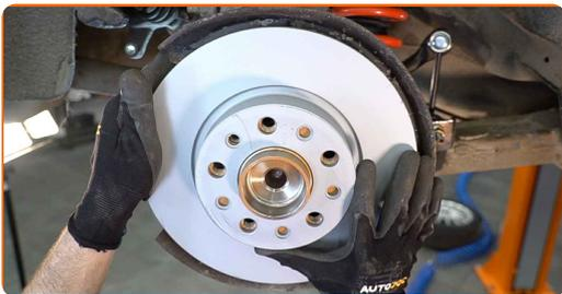
**19** Apriete la fijación del disco de freno. Use Vaso HEX No. H5. Utilice una llave dinamométrica. Apriételo a un par de 7 Nm.
