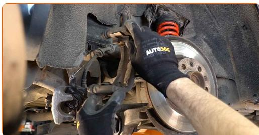
**14** Limpie las sujeciones del disco de freno. Use un cepillo de alambre. Use el aerosol WD-40.
