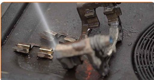
**22** Instale la pinza del cáliper de freno.
