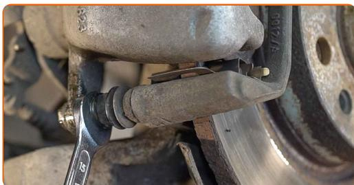
**9** Retire el soporte de freno. Use una palanca.
