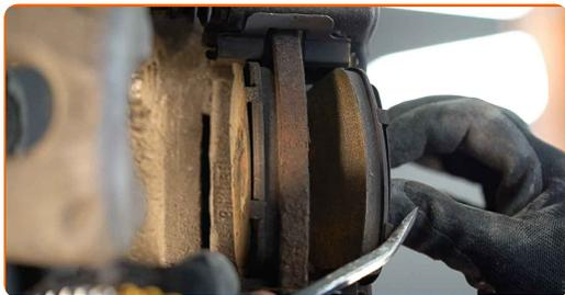
**11** Limpie las sujeciones del soporte de la pinza del freno. Use un cepillo de alambre. Use el aerosol WD-40.
