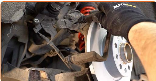
**23** Apriete la fijación de la pinza del cáliper de freno. Use un vaso de impacto del n.º E12. Utilice una llave dinamométrica. Apriételo a un par de 60 Nm.
