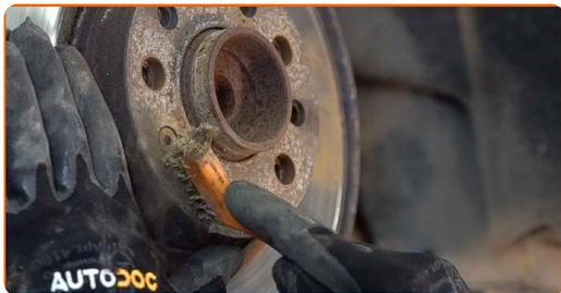
**15** Destornille la fijación del disco de freno. Use Vaso HEX No. H5. Utilice una llave de trinquete.
