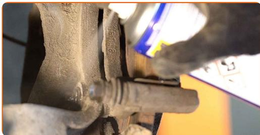
**12** Destornille la fijación de la pinza del cáliper de freno. Use un vaso de impacto del n.º E12. Utilice una llave giramachos.
