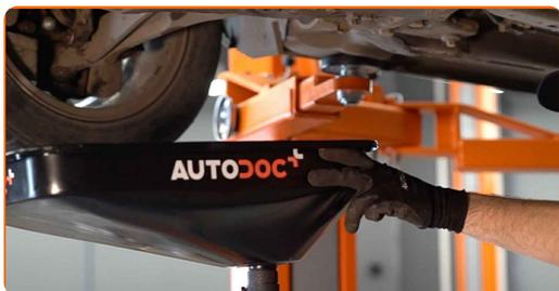
**6** Limpie el área del orificio de drenaje de la bandeja de aceite. Utilice un spray de limpieza multiuso.
