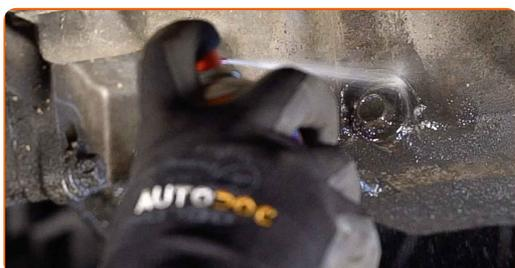
**7** Destornille el tapón de desagüe. Use un vaso de impacto del n.º 17. Utilice una llave de trinquete.
