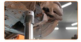
Atornille la sujeción trasera que conecta la mangueta de dirección trasera al brazo de control de la suspensión. Usa una llave mixta del n.º 22.
