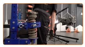
Destornille la tuerca de la varilla de la pata amortiguadora. Usa una llave mixta del n.º 17. Use un vaso de impacto del n.º 8. Utilice una llave de trinquete.
