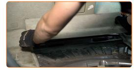
Retire los clips de sujeción del revestimiento de la parte lateral del maletero. Utilice una herramienta de extracción de clips.
