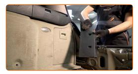
Retire la cubierta del revestimiento de la parte lateral del maletero.
