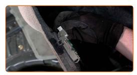
Desatornille la sujeción y retire el aislamiento acústico de la parte lateral del maletero.
