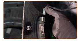
Instale los clips del revestimiento de la parte lateral del maletero.
