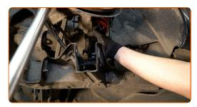
Atornillen la fijación superior de la cazoleta de la pata amortiguadora. No lo apriete.
