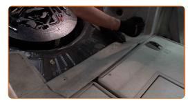
Instale los clips del revestimiento inferior de la parte delantera del maletero.
