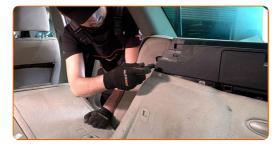
Retire el revestimiento de la parte lateral del maletero.
