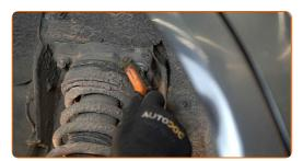
Destornille la fijación superior de la cazoleta de la pata amortiguadora. Use un vaso de impacto del n.º E14. Utilice una llave de trinquete.
