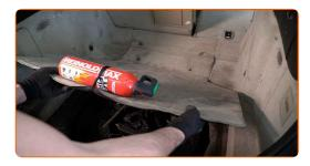
Retire los clips de sujeción del revestimiento inferior de la parte delantera del maletero. Utilice una herramienta de extracción de clips.
