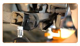
Instale el perno de sujeción. Use una palanca.
