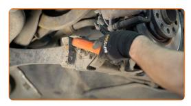
Haga una marca en el perno de ajuste de la inclinación.
