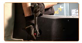
Desatornille las sujeciones del panel de plástico del revestimiento lateral. Utilice un destornillador Phillips.
