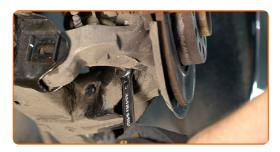
Retire el perno de sujeción.
