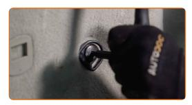
Instale la cubierta del revestimiento de la parte lateral del maletero.
