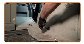
Desenrosque la sujeción del panel de plástico protector central. Utilice Torx T25. Utilice una llave de trinquete. Utilice un destornillador Phillips.
