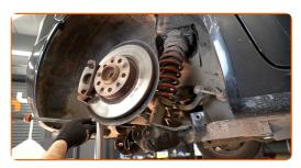
Retire la pata amortiguadora.
