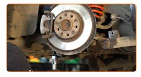
Apriete la sujeción trasera que conecta la mangueta de dirección trasera al brazo de control de la suspensión.
