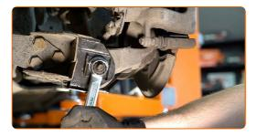
Retire el perno de sujeción. Use una palanca. Utilice un mazo de goma.
