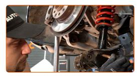
Limpie los asientos de montaje de la mangueta de dirección trasera. Use un cepillo de alambre. Use el aerosol WD-40.
