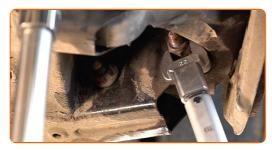
Trate las sujeciones de la mangueta de dirección trasera. Use grasa de cobre.
