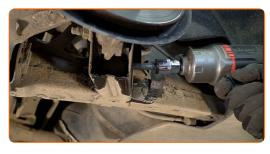
Limpie las sujeciones del soporte superior del puntal amortiguador. Use un cepillo de alambre. Use el aerosol WD-40.
