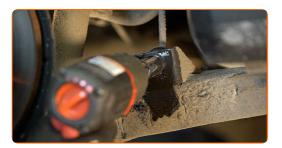
Limpie las sujeciones del amortiguador. Use un cepillo de alambre. Use el aerosol WD-40.
