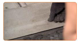
Instale el revestimento (forro) del cinturón de seguridad. Use un vaso de impacto del n.º 10.
