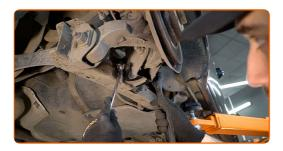
Retire el perno de sujeción.
