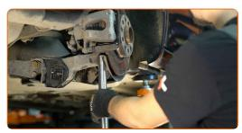
Destornille la tuerca de la varilla de la pata amortiguadora. Use un vaso de impacto del n.º 16.
