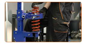
Instale el soporte de montaje superior del puntal y el cojinete del soporte de montaje del puntal.
