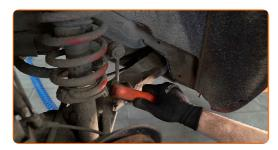
Desenrosque la sujeción que conecta la barra estabilizadora con el brazo de control. Use un vaso de impacto del n.º 18.
