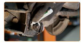
Desatornille la sujeción trasera que conecta la mangueta de direccion trasera al brazo de control de la suspensión. Usa una llave mixta del n.º 22.
