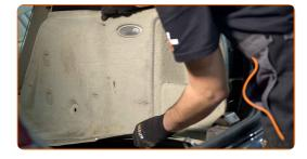
Retire el revestimiento (forro) del cinturón de seguridad. Use un vaso de impacto del n.º 10. Utilice una llave de trinquete.
