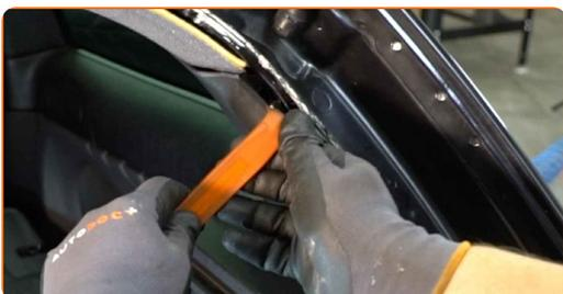
**14** Desatornille las sujeciones del panel de plástico del revestimiento lateral. Utilice un destornillador Phillips.
