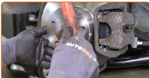
**72** Trate la superficie donde el disco del freno entra en contacto con la llanta de la rueda. Use grasa de cobre.
