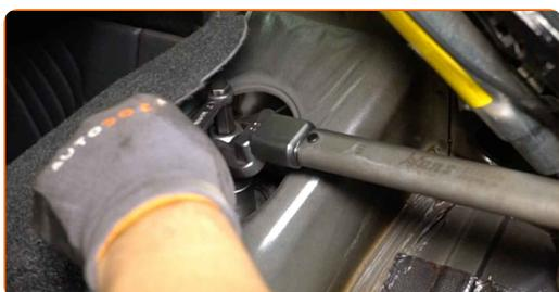
**79** Trate la sujeción superior del soporte del puntal de suspensión. Use grasa de cobre.
