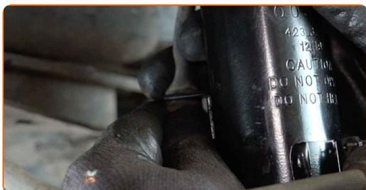
**70** Trate las sujeciones del amortiguador. Trate todas las juntas de la bieleta o enlace estabilizador. Trate las sujeciones de la mangueta de dirección trasera. Use grasa de cobre.
