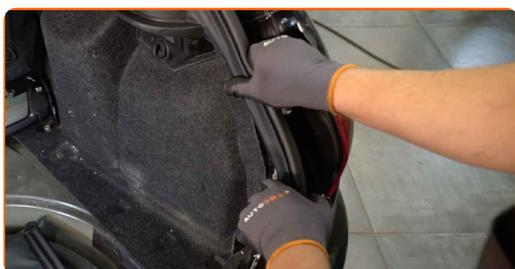
**10** Retire la luz interior del maletero. Utilice una herramienta de recorte de plástico.
