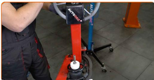
**48** Instale el soporte de montaje superior del puntal y el cojinete del soporte de montaje del puntal.
