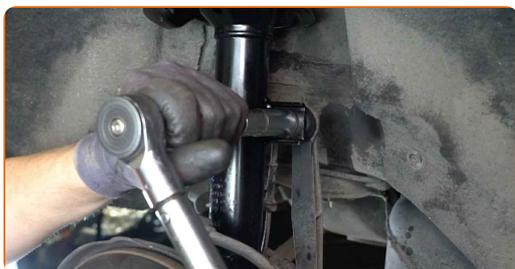
**67** En la pata fije el latiguillo del sistema de freno.
