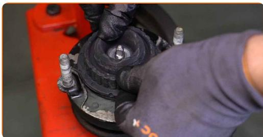
**33** Apriete la tuerca de la varilla de la pata amortiguadora. Utilice un vaso para amortiguador DDN<sup>06</sup> Use un vaso de impacto del n.º 16. Utilice una llave dinamométrica. Apriételo a un par de 35 Nm.
