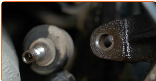
**15** Limpie el perno de sujeción que conecta la horquilla del amortiguador con el brazo de control inferior. Use un cepillo de alambre. Use el aerosol WD-40.
