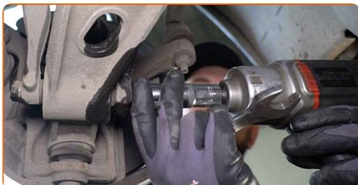
**17** Limpie las sujeciones del brazo de control. Use un cepillo de alambre. Use el aerosol WD-40.
