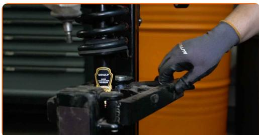
**37** Limpie los asientos de montaje del amortiguador. Use un cepillo de alambre. Use el aerosol WD-40.
