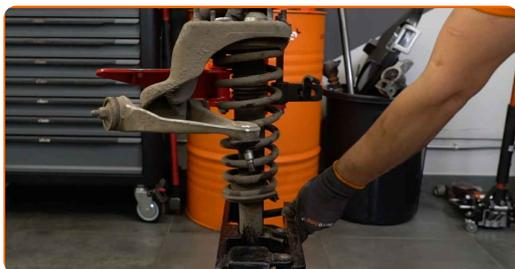
Sustitución: copelas del amortiguador - ALFA ROMEO GT (937). AUTODOC recomienda:
