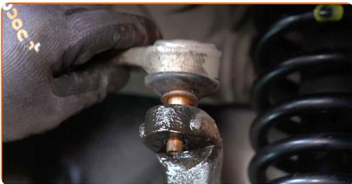
**44** Atornille la sujeción que conecta el brazo de suspensión con la mangueta de dirección. Use un vaso de impacto del n.º 17. Utilice una llave de trinquete.
