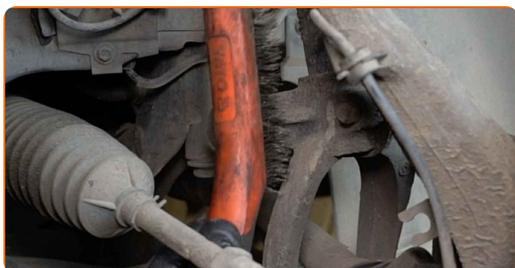
**13** Deshaga la tuerca de sujeción que conecta la bieleta de barra estabilizadora con la horquilla del amortiguador. Use un vaso de impacto del n.º 17. Utilice una llave de trinquete.
