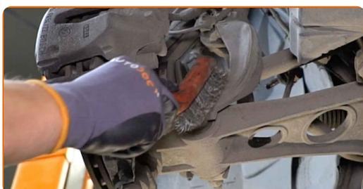
**16** Desenrosque el perno de sujeción que conecta la horquilla del amortiguador con el brazo de control inferior. Usa una llave mixta del n.º 19. Use un vaso de impacto del n.º 19. Utilice una llave de trinquete.
