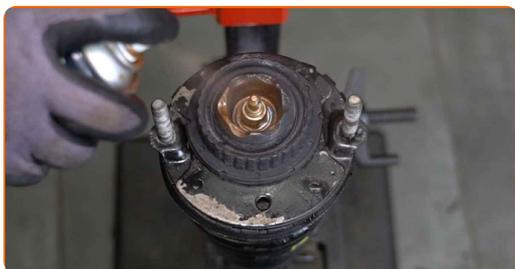
**36** Retire el puntal amortiguador que está montado.
