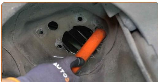
**38** Instale la pata amortiguadora en el arco de la rueda.
