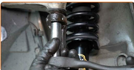
**45** Limpie los asientos de montaje de la bieleta de barra estabilizadora. Use un cepillo de alambre. Use el aerosol WD-40.
