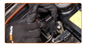
Destornille la atadura de la bobina del encendido. Utilice Torx T40. Utilice una llave de trinquete.
