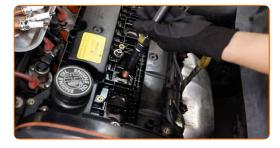
Atornille las buujías nuevas y apriételas. Use el vaso de bujía # 16. Utilice una llave dinamométrica. Apriételo a un par de 24 Nm.
