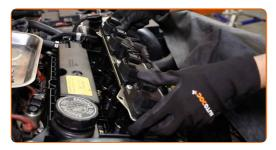
Apriete la atadura de la bobina del encendido. Utilice Torx T40. Utilice una llave dinamométrica. Apriételo a un par de 7 Nm.
