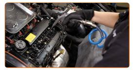
Desenrosque las bujías. Use el vaso de bujía # 16. Utilice una llave de trinquete.
