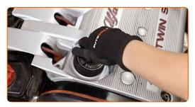
Atornille las sujeciones de la cubierta del motor. Utilice Torx T40. Utilice una llave de trinquete.
