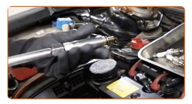
Aplique una capa fina de un lubricante antigripado especial de alta temperatura a las roscas de las nuevas bujías.
