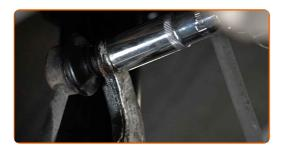
9 Retire el enlace estabilizador de estabilidad transversal.
