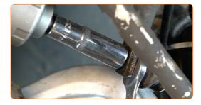
Apriete la sujeción que conecta la bieleta de barra estabilizadora al amortiguador. Use un vaso de impacto del n.º 17. Utilice una llave dinamométrica. Apriételo a un par de 65 Nm.
