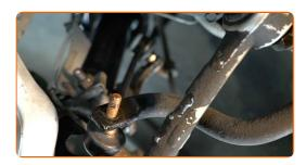
Apriete las fijaciones de la bieleta de la barra estabilizadora. Usa una llave mixta del n.º 17. Use un vaso de impacto del n.º 17. Utilice una llave de trinquete.
