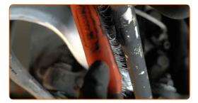
Desatornille la sujeción que conecta la bieleta a la barra estabilizadora. Use un vaso de impacto del n.º 17. Utilice una llave de trinquete.
