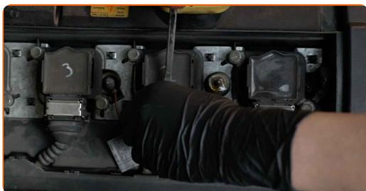
**11** Desatornille las sujeciones de las bobinas del encendido. Use un vaso de impacto del n.º 10. Utilice una llave de trinquete.
