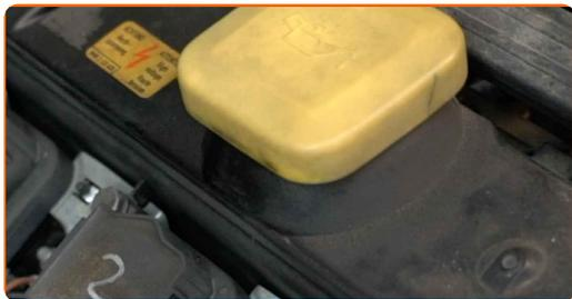
**10** Desconecte los conectores de las bobinas del encendido. Use una palanca.
