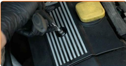
**29** Instale la carcasa del conducto de aire.
