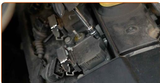
**12** Extraiga las bobinas del encendido de los pozos de la bujía.
