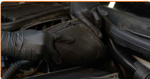
**6** Desatornille la sujeción de la cubierta del motor. Use un vaso de impacto del n.º 10. Utilice una llave de trinquete.
