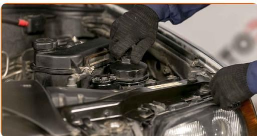
**14.2** Use un vaso de impacto del n.º 36. Utilice una llave dinamométrica. Apriételo a un par de 25 Nm.
