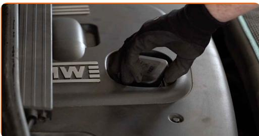
**4** Destornille la tapa del cuerpo del filtro junto con el elemento filtrante antiguo. Use un vaso de impacto del n.º 36. Utilice una llave de trinquete.
