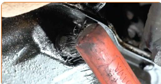
**8** Destornille el tapón de desagüe. Use un vaso de impacto del n.º 14. Utilice una llave de trinquete.
