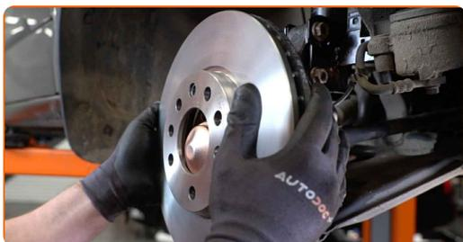
**21** Apriete la fijación del disco de freno. Utilice Torx T30. Utilice una llave dinamométrica. Apriételo a un par de 7 Nm.
