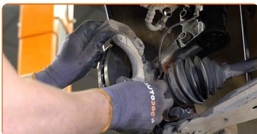
**24** Apriete la fijación de la pinza del cáliper de freno. Use un vaso de impacto del n.º 18. Utilice una llave dinamométrica. Apriételo a un par de 100 Nm.
