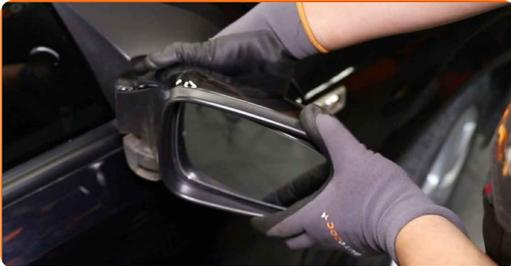
**2** Suelte con cuidado el cristal del espejo de su sujeción. Utilice una herramienta de recorte de plástico.
