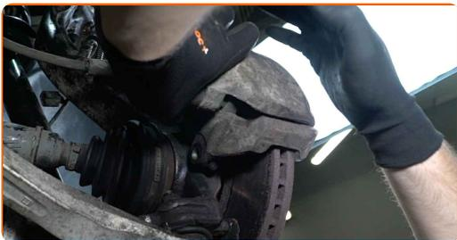
**70** Apriete la fijación de la pinza del cáliper de freno. Use un vaso de impacto del n.º 17. Utilice una llave dinamométrica. Apriételo a un par de 130 Nm.
