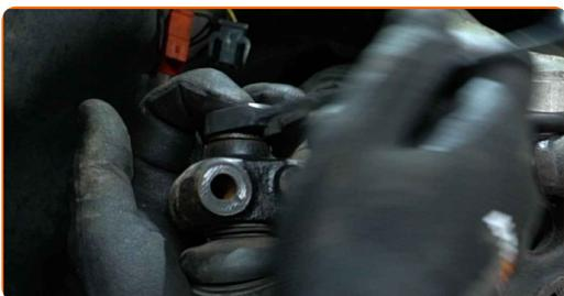
**21** Retire el perno de sujeción.
