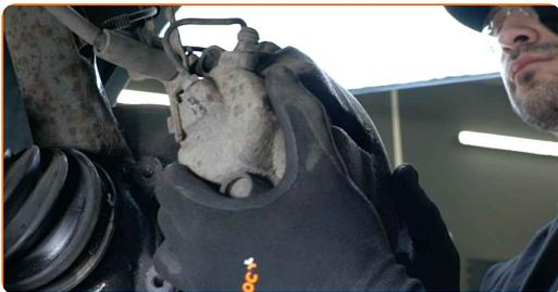
**14** Retire el perno de sujeción. Use un vaso de impacto del n.º 27.
