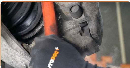
**12** Destornille la fijación de la pinza del cáliper de freno. Use un vaso de impacto del n.º 17. Utilice una llave de trinquete. Utilice una llave giramachos.
