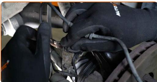
**72** Trate el conector del sensor ABS. Utilice grasa dieléctrica.
