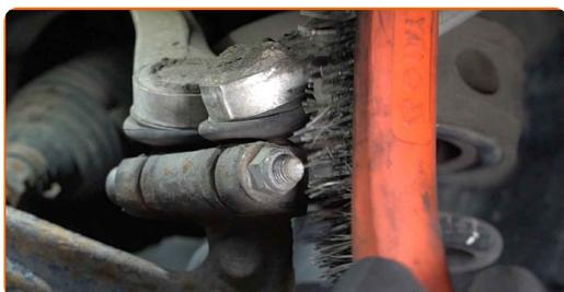
**17** Destornille la fijación de las palancas superiores. Use un vaso de impacto del n.º 16. Use Vaso HEX No. H8. Utilice una llave de trinquete.
