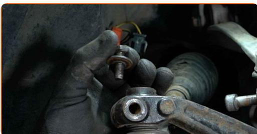
**22** Extienda las lengüetas para el perno de fijación en el extremo de la barra de dirección. Utilice un cincel de metal plano. Utilice un martillo.
