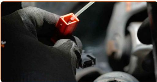
**73** Conecte el conector del sensor ABS.
