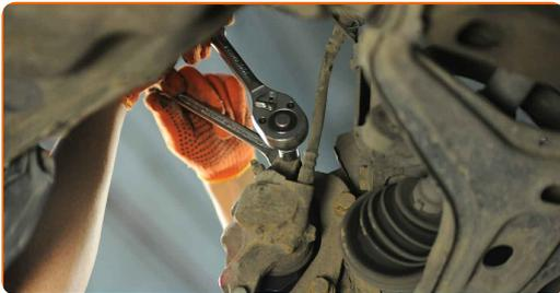
**18** Trate la superficie donde el disco del freno entra en contacto con la llanta de la rueda. Utilice grasa cerámica para altas temperaturas.
