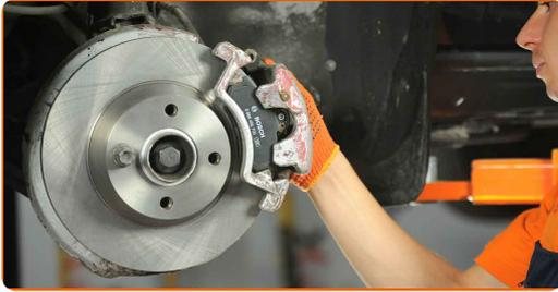
**17.2** Usa una llave mixta del n.º 15. Use un vaso de impacto del n.º 13. Utilice una llave dinamométrica. Apriételo a un par de 35 Nm.
