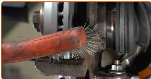
15 Trate las pastillas de freno en el área donde su superficie entra en contacto con el soporte de la pinza de freno. Use pasta antichirridos.
