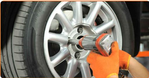
22 Baje el automóvil y, manteniendo el orden cruzado, apriete los pernos de fijación de las ruedas. Utilice una llave de impacto para llanta # 17. Utilice una llave dinamométrica. Apriételo a un par de 120 Nm.
