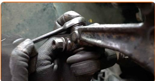
**44** Instale el perno de sujeción.
