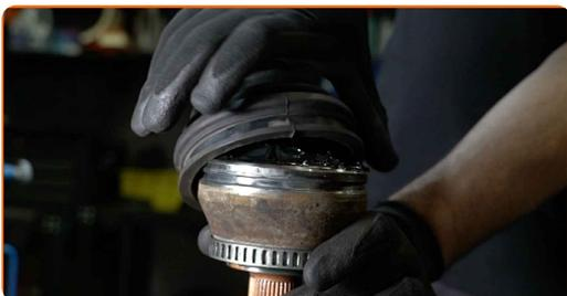
**30** Limpie el asiento de montaje de la junta homocinética. Utilice un spray de limpieza multiuso.
