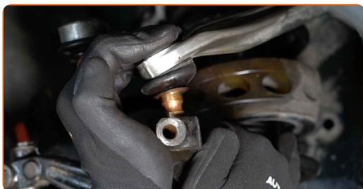
**48** Instale el perno de sujeción. Use una palanca.
