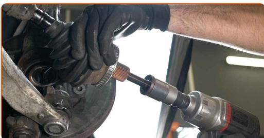
**27** Retire el perno de sujeción.
