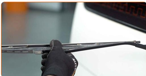
**3** Gire la escobilla del limpiaparabrisas a 90 grados. Retire la escobilla del brazo del limpiaparabrisas.
