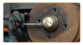
Retire el pasador de chaveta que fija la tuerca del cubo. Use una palanca. Utilice un martillo.
