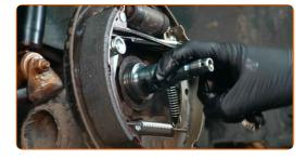
Instale el nuevo tambor de freno ensamblado junto con el cojinete del cubo de rueda.
