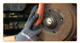
Retire la tapa de la tuerca del cubo de rueda. Use una palanca. Utilice un martillo.
