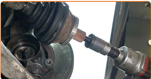
**26** Desenrosque la fijación que conecta el eje de transmisión al cubo de la rueda.
