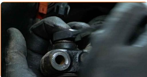
**15** Retire el perno de sujeción. Use un punzón. Utilice un martillo.
