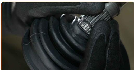
**33** Instale el anillo de seguridad de la junta homocinética.
