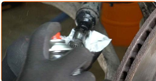
**31** Retire el anillo de seguridad de la junta homocinética. Utilice un destornillador plano.
