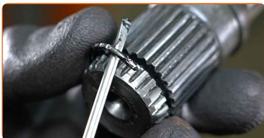
**32** Instale el fuelle de la junta homocinética en el palier. Utilice un destornillador plano.
