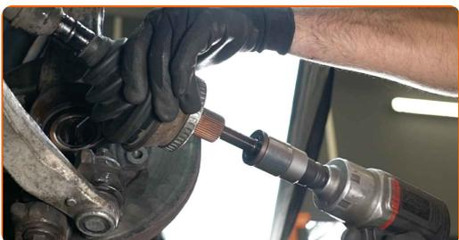
**27** Retire el perno de sujeción.
