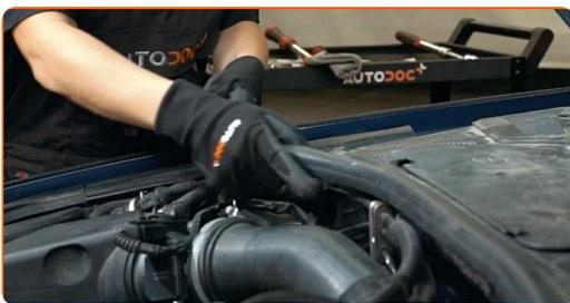
**4** Desenrosque las sujeciones de la rejilla del limpiaparabrisas. Utilice Torx T20. Utilice un destornillador plano.
