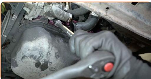
**9** Retire la carcasa del termostato.
