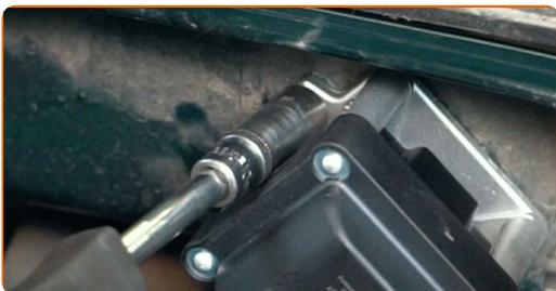
**11** Trate el conector de la bobina de encendido con spray para electrónica. El spray protegerá los contactos eléctricos de la corrosión, oxidación, y reducirá la resistencia de contacto.
