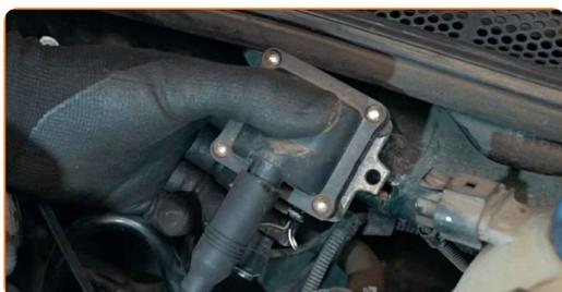
**5** Desconecte el cable de alta tensión.
