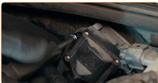
**4** Retire la bobina de encendido.
