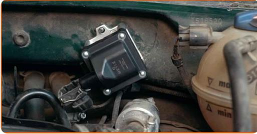
**10** Apriete la atadura de la bobina del encendido. Use un vaso de impacto del n.º 10. Utilice una llave dinamométrica. Apriételo a un par de 7 Nm.
