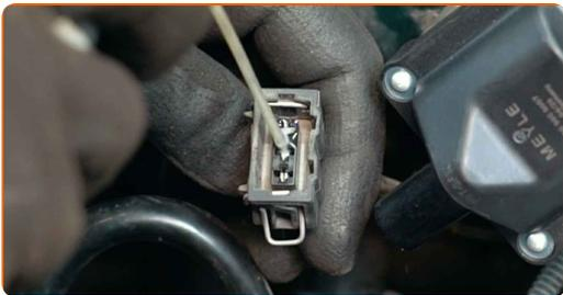
**12** Enchufe el conector de la bobina de encendido.
